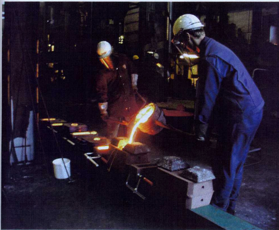
Pouring of Test Moulds
