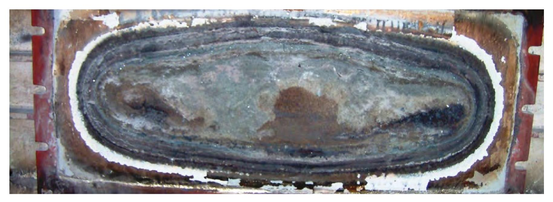
Este es un horno vertical de 35 toneladas que funde hierro en base gris y nodular. Un precipitado común insoluble en la formación inicial de adherencia es el Silicato de Aluminio, 3Al2O3-2SiO2 (Mullita)
