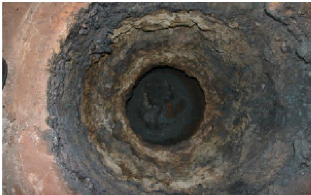
recubrimiento refractario” inesperado en su horno de inducción sin núcleo de 500 lb., a razón de 25 mm (1”) por día. Como se muestra arriba, en dos días de operación se obtuvo una capa de adherencia de 2 pulgadas. Se intentó quitarla mecánicamente con un martillo pero la preocupación de dañar el refractario impidió que esta fuera una solución viable. Esto se convirtió en una situación de emergencia por la rápida reducción de capacidad del horno y su consiguiente baja de producción.
